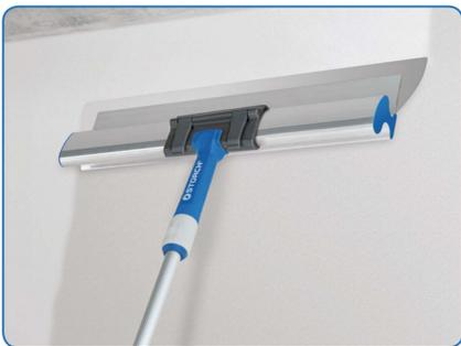
Обратите внимание на дополнительное приспособление к шпателю (см.рисунок справа). Это специальный адаптер для шпателя AluSTAR под телескопическую удочку с подвижным быстроразъемным соединением "LOCK-IT" крепится к рукоятке инструмента и применяют для финишной шпатлевки стен или потолков без использования специальных подмостей, стремянок или [строительных ходуль](#).
